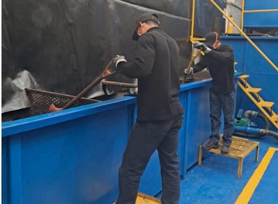
Tras la homogeneización, el material es tratado mediante un proceso electroquímico, que combina la inyección de electricidad con la adición de sustancias químicas. Este procedimiento permite romper los enlaces químicos de los contaminantes presentes, generando tres fracciones:
